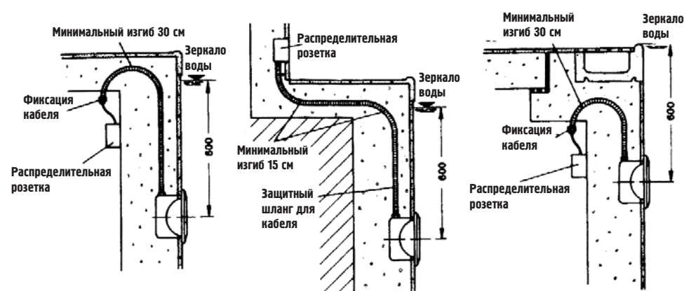
Рис. 238. Прокладывание защитного кабеля в бассейнах различных типов
